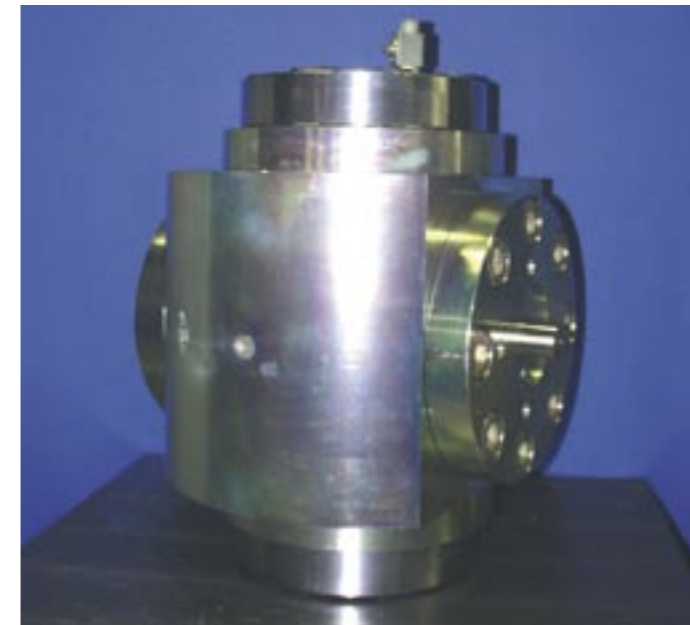
Kugelhahn für einen Prüfstand. Die Kundenforderung bestand darin, hohen Druck und großes Volumen in kurzer Zeit auf einen Prüfling aufzubringen.
