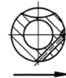
Durchflussrichtung Kugel bei geschlossenem Kugelhahn Flow through direction of ball when ball valve is closed
