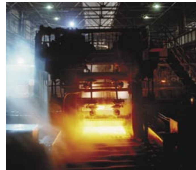
Entzunderung von Stahlblechen und Profilen. Descaling of steel sheets and profiles.
