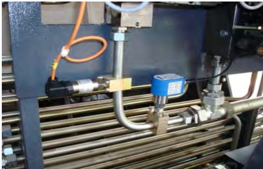
Abbildung 2: Rohrmessanschluss Serv-Clip ® -1 mit Drucksensor—Gewindeanschluss G 1/4"
