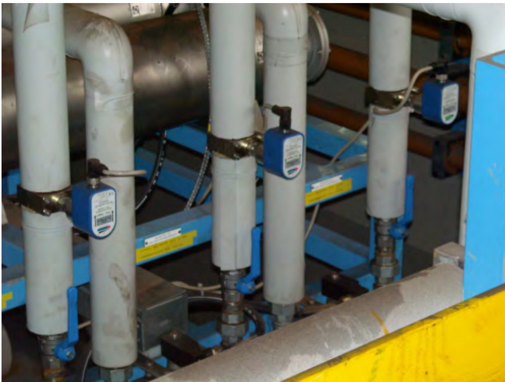
Abbildung 4: Überwachung einer Einfettölanlage mit Volumenstromsensoren und Serv-Clip ® -2 an einer Durchlaufheizlinie
