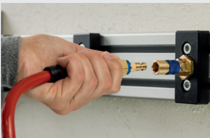
Einhandbedienung: Verbindung durch Eindrücken des Stecknippels in die Kupplung (Die Farben der Aluminiumhülse der Kupplung und des Aluminiumrings des Stecknippels sowie die Steckcodierung müssen übereinstimmen.)
