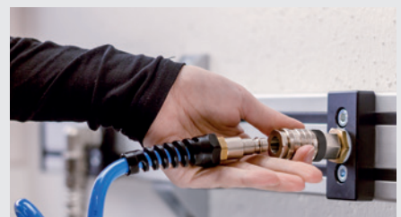
Entkuppeln: Trennung von Kupplung und Stecknippel nach Zurückschrauben der Kontermutter
