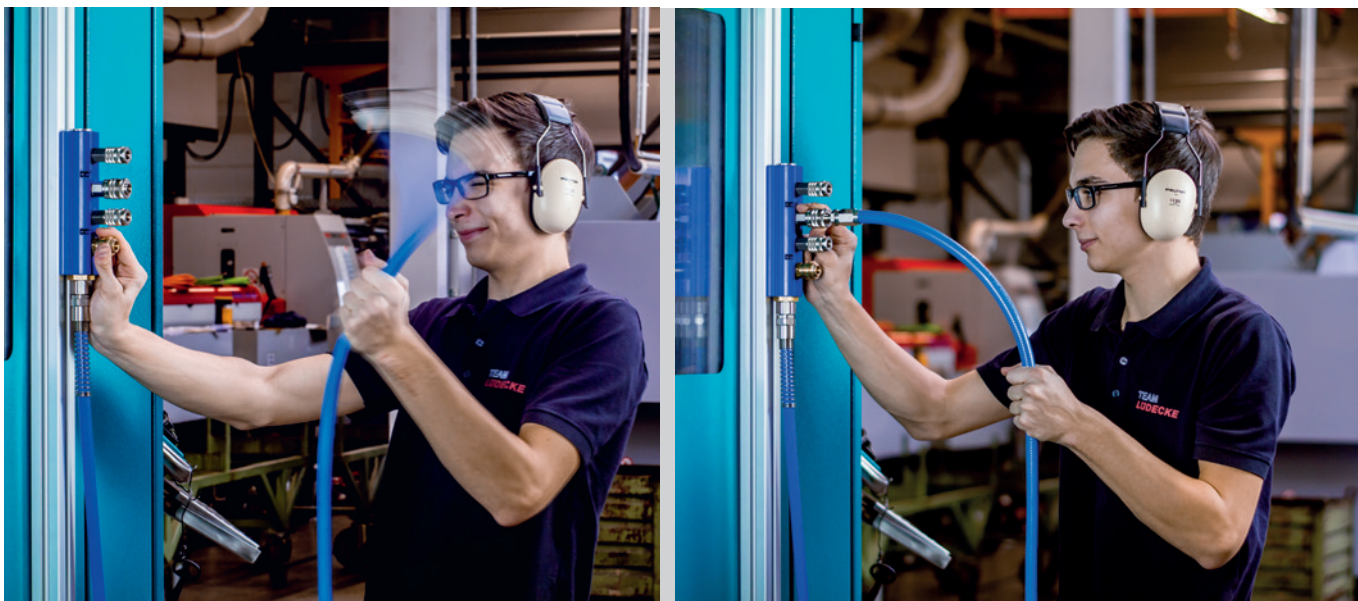
Der Peitschenhiebeeffect: eine große Gefahr in der Anwendung von Druckluft - vermieden durch Produkte der LUDECKE SafeConnect-Line .
