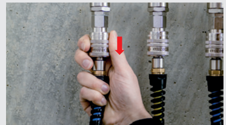
Entkuppeln - Stufe 2: gefahrloses Entkuppeln
