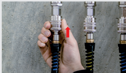
Entkuppeln - Stufe 1: Automatisches Entlüften
