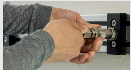
Zweihandbedienung: Entkuppeln durch Drücken des Stecknippels und parallelem Verschieben der Kupplungshülse
