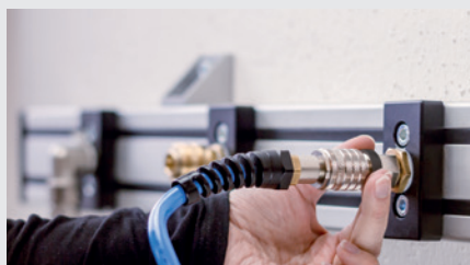
Sicherung durch Gegenschrauben der Kontermutter
