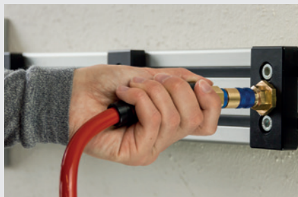
Einhandbedienung: Verbindung durch Eindrücken des Stecknippels in die Kupplung (Die Farben der Aluminiumhülse der Kupplung und des Aluminiumrings des Stecknippels sowie die Steckcodierung müssen übereinstimmen.)
