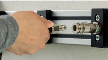
Einhandbedienung: Verbindung durch Eindrücken des Stecknippels in die Kupplung.
