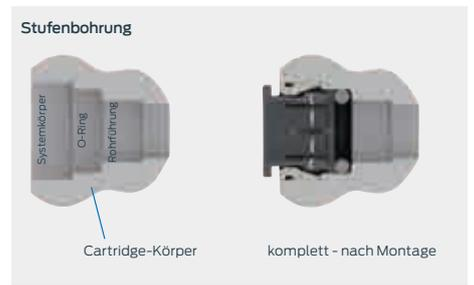
Wie fest die Edelstahlzähne in dem Gehäuse halten, hängt von der Festigkeit des Gehäusematerials ab. Wenn das System unter Druck steht, wird die Cartridge durch die Edelstahlzähne im Körper gehalten. Je höher der Druck, desto fester greifen die Edelstahlzähne des Cartridge-Körpers im Bauteilgehäuse.
