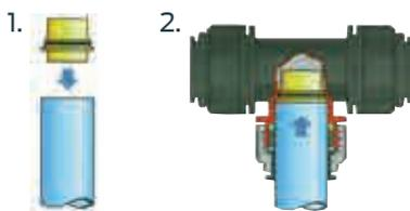
1. Den kurzen Teil des Einsatzes WTC28 in das 28 mm JG Kunststoffrohr PA-RM2823... (oder Aluminium- bzw. Kupferrohr) stecken.
