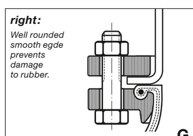
ELAFLEX-Gummikompensatoren werden einbaufertig geliefert. Die Standard-Flansche sind drehbar in jede gewünschte Position. Zusätzliche Dichtungen sind üblicherweise nicht erforderlich. Bei der Montage ist folgendes zu beachten:
